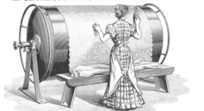
Von innen dampfheizter Zylinder der Firma Stute & Blumenthal. Zylinderlänge 2m, Zylinderumfang 4m. Gewicht: ca. 230 kg.
